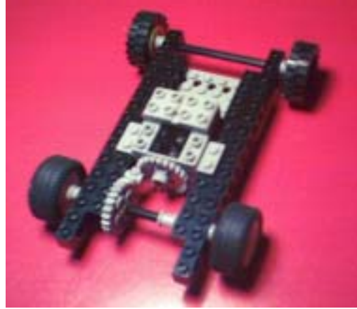
Figur 4 Udveksling fra motor til hjul.
